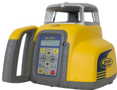
Il livelli laser GL 412 N realizza piani inclinati in singola pendenza in digitale da -10% a +15%. Comandabili a distanza tramite radiocomando, sono dotati di sensore vibrazioni, vento e temperatura; possibilità di disattivare le finestre di lavoro per evitare riflessi e interferenze.
